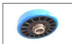
OTRL002 ID:GAA290CF1 GAA207K1 RSR Step Chain Roller OD76mm W22mm ID12.7mm
