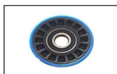
OTRL003 ID:GAA290CF2 Step Chain Roller OD76mm W22mm 6203RSR
